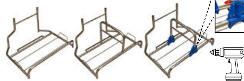
Posizionare sopra la base cromata il porta strizzatore e fissare le 2 parti con le apposite flange in nylon .Avvitare le viti autofilettanti con trapano avvitatore.
